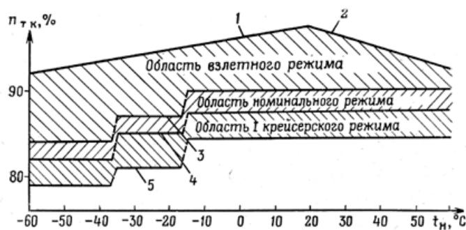
**Рис. 7.** Зависимость числа оборотов турбокомпрессора от температуры воздуха на входе в двигатель ( $H=0$ ):
