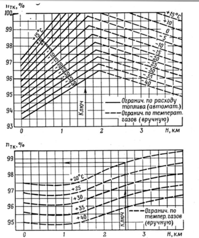
Рис. 38. График зависимости взлетных оборотов турбокомпрессора двигателя ГТД-350 от высоты расположения площадки над уровнем моря при различных температурах наружного воздуха
