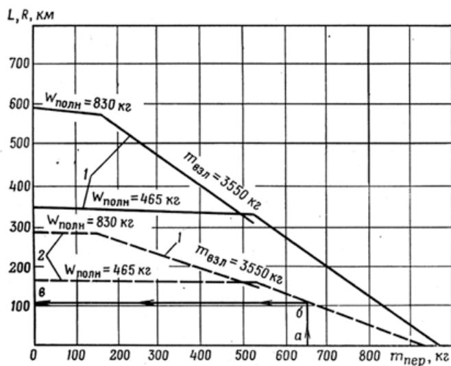
Рис. 20. Радиус и дальность полета на высоте 100 м в зависимости от массы переменного груза ( $V_{\text{пр}} = 180-190 \text{ км/ч}$ ;  $V_{\text{ст}} = 170-180 \text{ км/ч}$ ):
