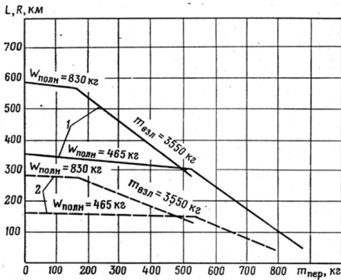
Рис. 24. Радиус и дальность полета на высоте 3000 м в зависимости от массы переменного груза ( $V_{\text{пр}} = 120 \text{ км/ч}$ ;  $V_{\text{ст}} = 140 \text{ км/ч}$ ):
