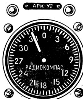
Рис. 45. Указатель радиокомпаса СУП-7
