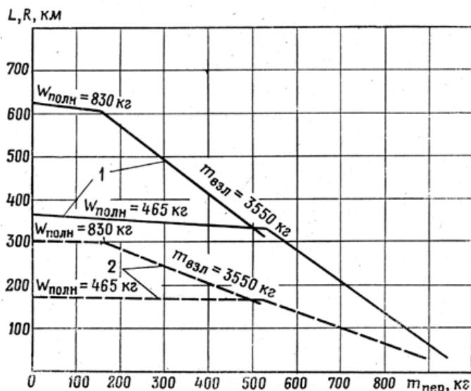
Рис. 23. Радиус и дальность полета на высоте 2000 м в зависимости от массы переменного груза ( $V_{\text{пр}} = 160 \text{ км/ч}; V_{\text{ст}} = 170 \text{ км/ч}$ ):
