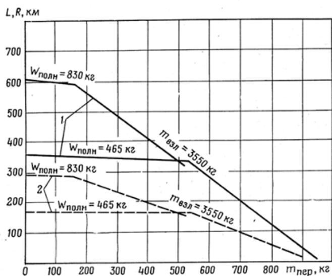
Рис. 21. Радиус и дальность полета на высоте 500 м в зависимости от массы переменного груза ( $V_{\text{пр}} = 180-190 \text{ км/ч}$ ;  $V_{\text{ст}} = 175-185 \text{ км/ч}$ ):
