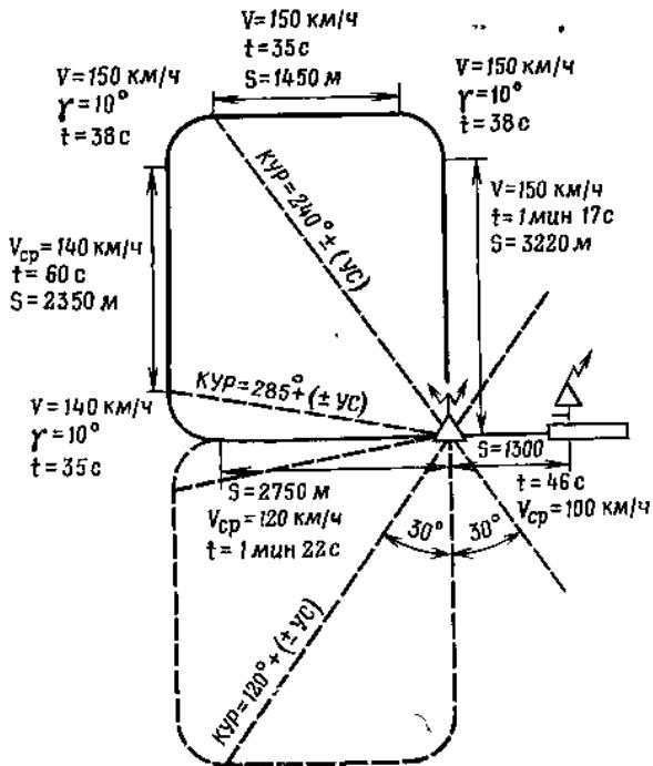
Рис. 12. Схема захода на посадку по малой коробочке
