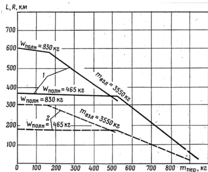
Рис. 22. Радиус и дальность полета на высоте 1000 м в зависимости от массы переменного груза ( $V_{\text{пр}} = 180-190 \text{ км/ч}; V_{\text{ст}} = 180-190 \text{ км/ч}$ ):
