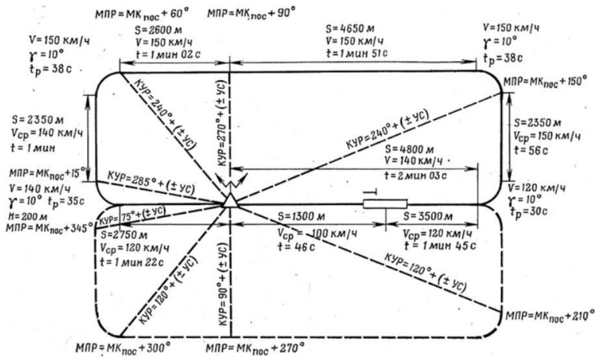
Рис. 8. Схема захода на посадку по большой коробочке
