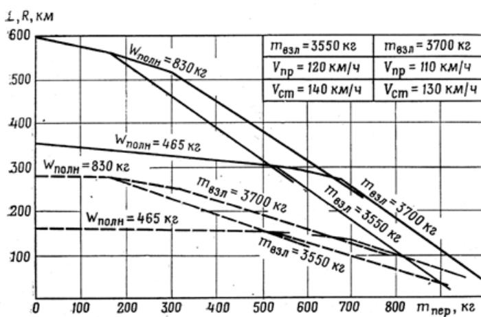
Рис. 32. Зависимость дальности и радиуса полета на высоте 3000 м от массы десантной нагрузки
