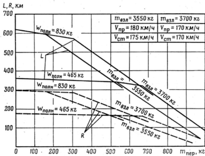
Рис. 29. Зависимость дальности и радиуса полета на высоте 500 м от массы десантной нагрузки
