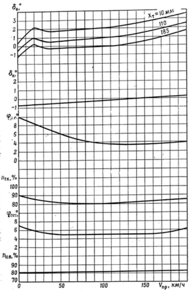
Рис. 40. Балансировочные кривые по скорости горизонтального полета при различных центровках вертолета
