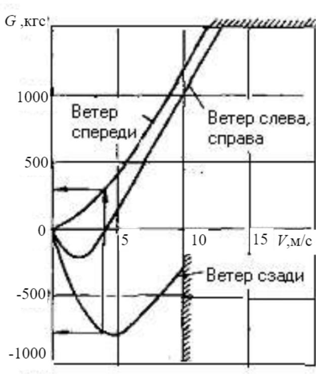
**Рис. 1.2.** Номограмма для определения приращения предельного веса в зависимости от скорости и направления ветра при взлете и посадке без использования влияния земли
