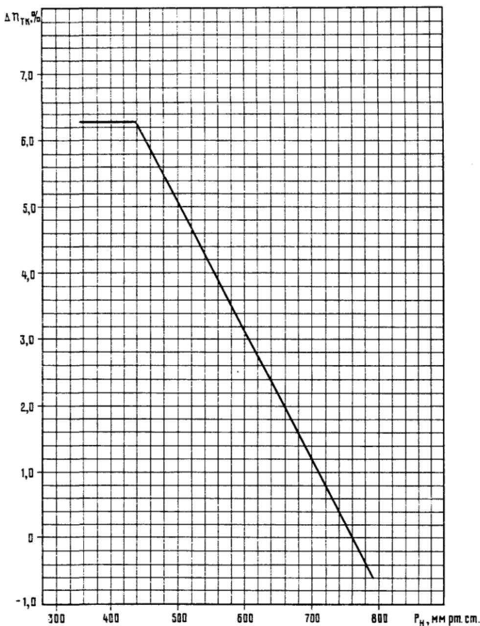
График для определения поправок  $\Delta n_{TK}$  для взлетного режима
