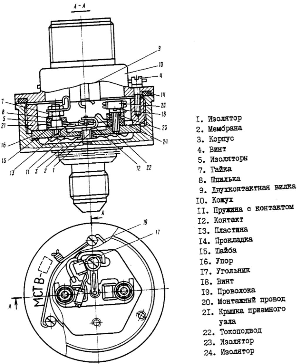
Конструкция сигнализатора минимального давления масла
