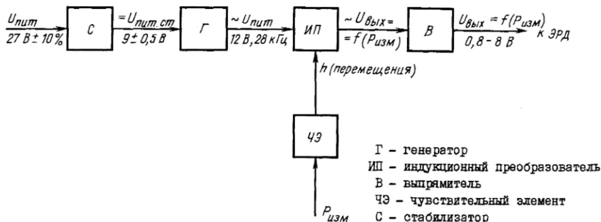
Структурная схема измерительного комплекса давления
