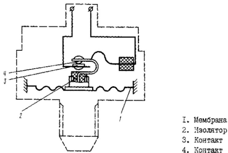
Принципиальная схема сигнализатора
