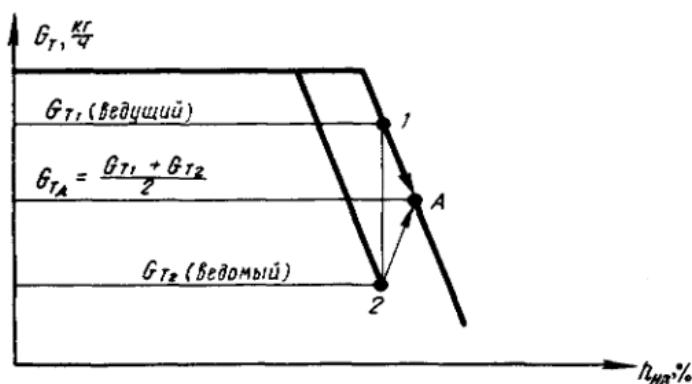
Смещение характеристики регулятора синхронизатором мощности
