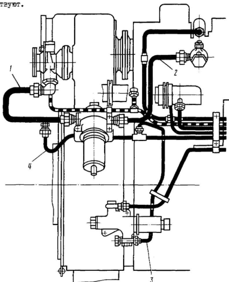
1. Трубопровод подвода топлива от ДДН к фильтру
