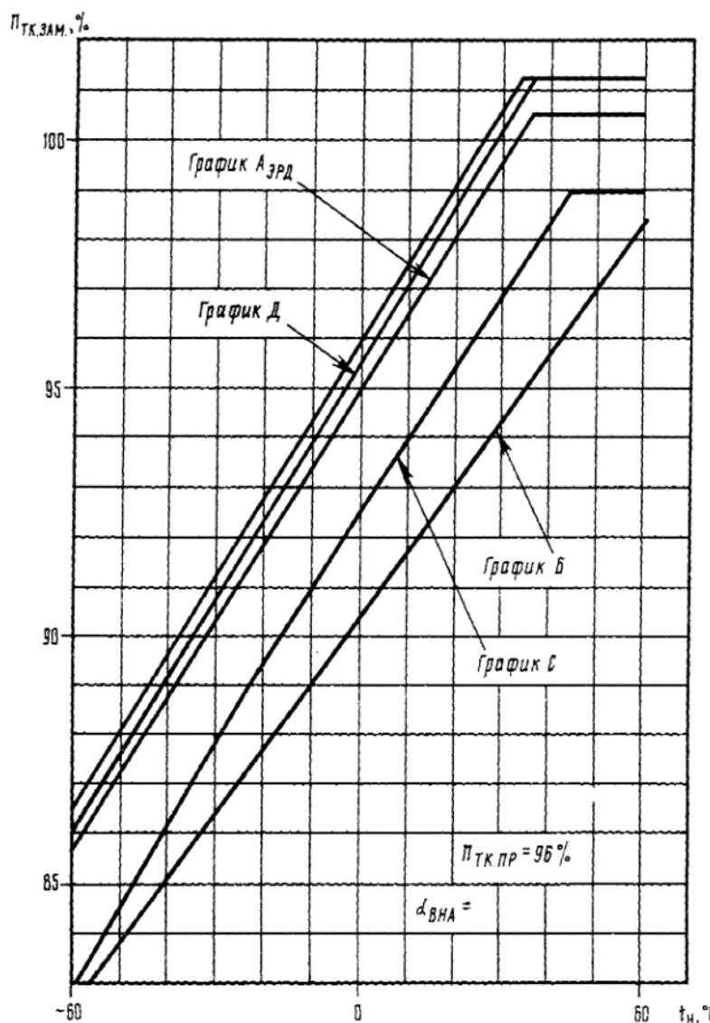
График А<sub>ЭРД</sub> - зависимость замеренной частоты вращения ротора турбокомпрессора от температуры воздуха на входе в термопатрон на взлетном режиме;
