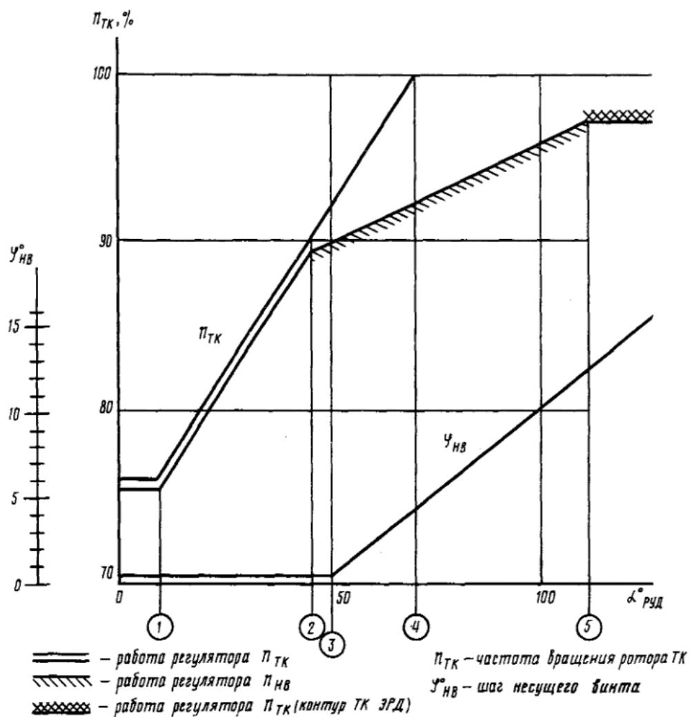
Зависимость параметров силовой установки от угла поворота РУД
