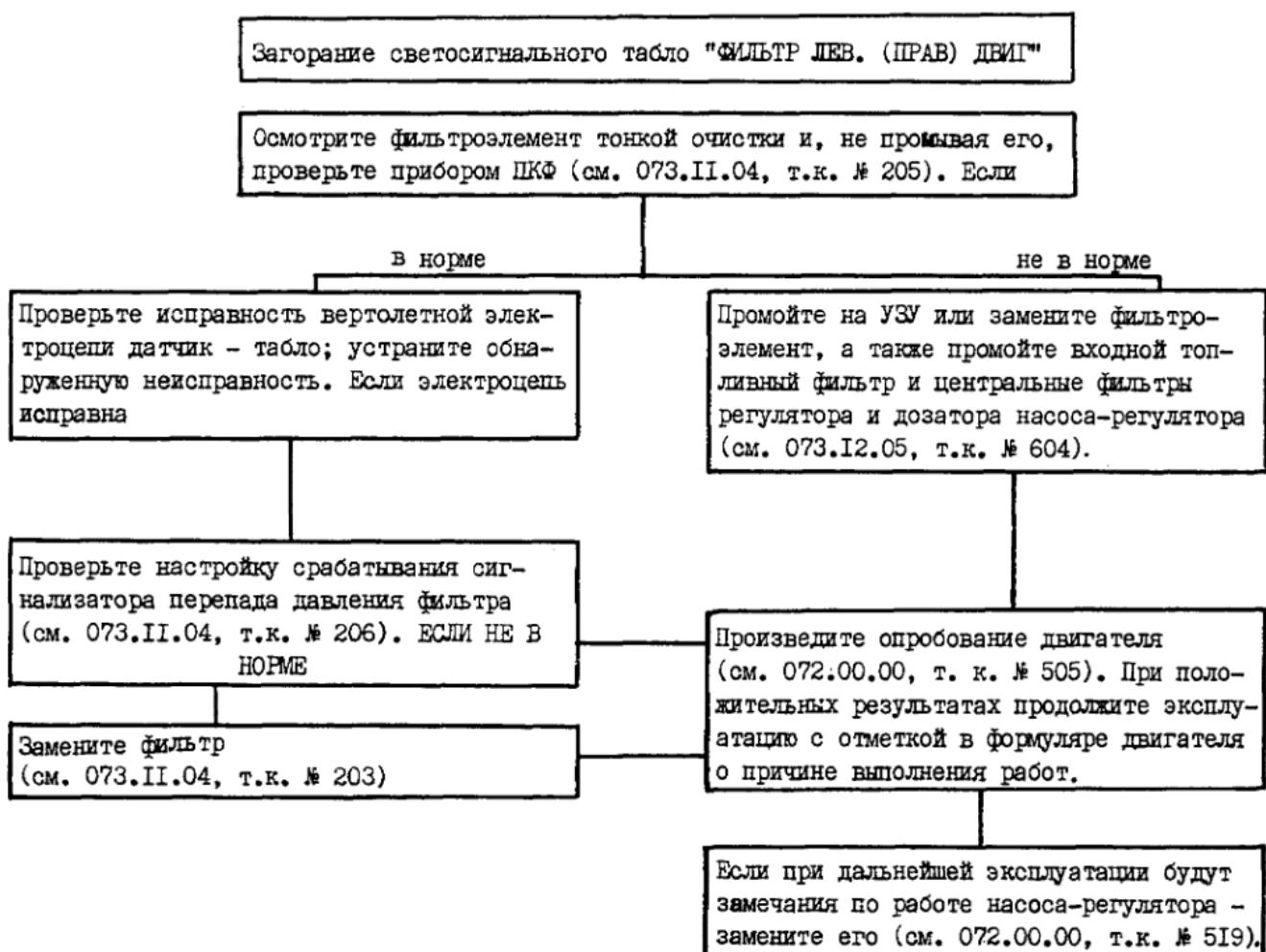
СХЕМА ОТЫСКАНИЯ И УСТРАНЕНИЯ НЕИСПРАВНОСТИ
