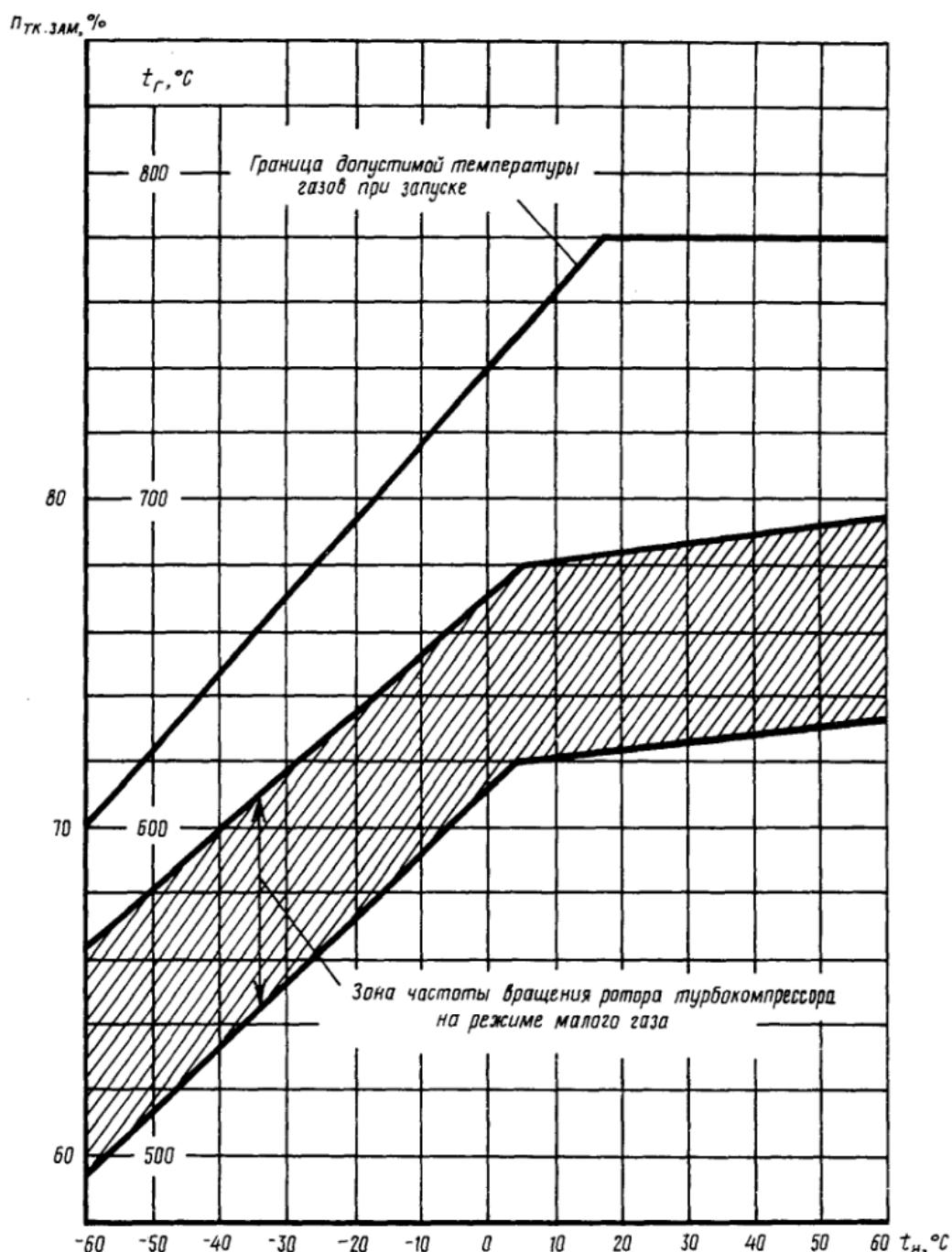
Зависимость частоты вращения ротора турбокомпрессора на режиме малого газа и максимально допустимой температуры газов при запуске (по термопарам Т-102) от температуры наружного воздуха
